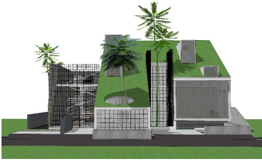
Gambar 2. Prinsip Insulate , Orientation dan Zone Dalam Tema Arsitektur Bioklimatik Pada Rancangan Tampilan Bangunan Kedai Kopi [Sumber: Analisa Pribadi, 2024]
