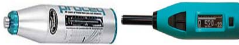
Gambar 2.1 Contoh alat hammer manual dan digital dari Proceq . (Mulyati dan Febrianto,2011)
