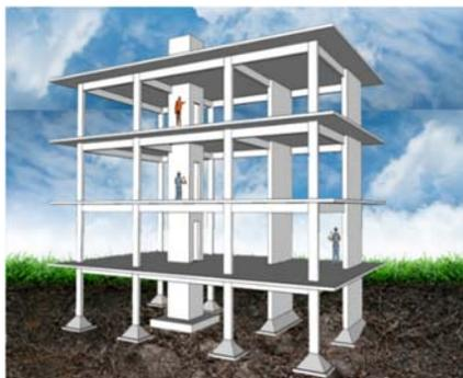
Gambar 8. Struktur Rangka Beton
